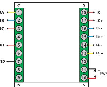
接线说明：1、2、3、13、14、15、16、17、18位端子为输入端子，5、7位端子为输出端子，10、11位端子为电源端子
